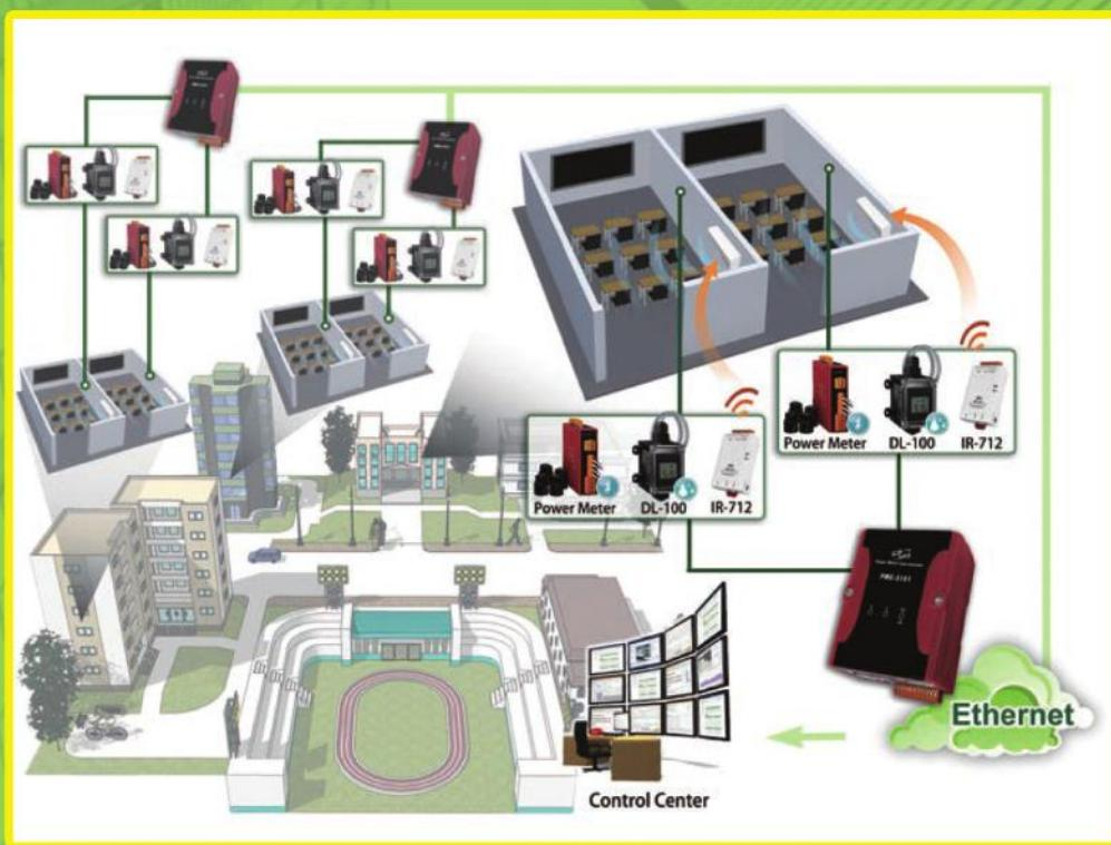
از ICP DAS PMMS(Power Monitor & Management Solution)، برای نظارت بر تهويه مطبوع و مصرف برق ورزشگاه ها مورد استفاده قرار گرفته است. با استفاده از PMMS، کاربر می تواند اطلاعات مصرف برق را در هر قسمت از ساختمان و دستگاه های الکتریکی در زمان واقعی مشاهده کند و همچنین می تواند آنالیز کند، ارزیابی کند و مصرف وسایل الکتریکی را مدیریت کند. با این کار قبض برق خود را کاهش می دهد و از جریمهٔ مصرف بیش از ظرفیت قرارداد جلوگیری می کند.
